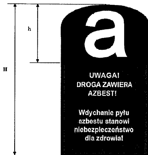
Rysunek 6. Wzór oznakowania dróg utwardzonych odpadami zawierającymi azbest przed wejściem w życie Ustawy z dnia 19 czerwca 1997 r. o zakazie stosowania wyrobów zawierających azbest, ale niezabezpieczonych trwale przed emisją włókien azbestu
